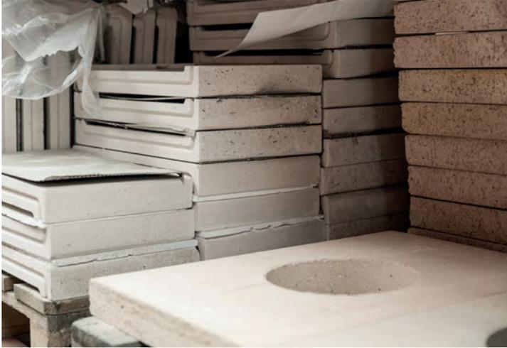
Notre chamotte et béton réfractaires sont cuits à une température de 1100 ° C. Ceci permet de les utiliser dans des foyer où pendant la flambée de très hautes températures peuvent être atteintes. Hoxter utilise uniquement des matériaux cuits pour tous ses foyers.
