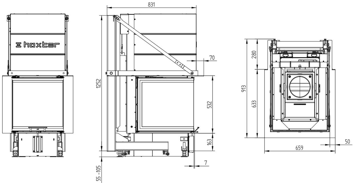
UKA 56/50/56/52h Ossatures incl. cadre de montage 8 côtés 70 mm
