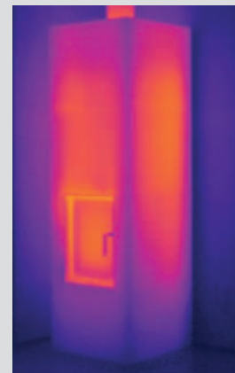
12 heures après l'allumage Température moyenne de la surface 45 °C
