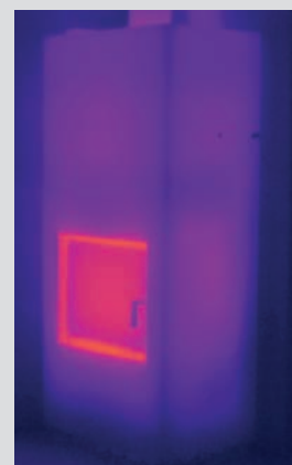
3 heures après l'allumage Température moyenne de surface 37 °C
