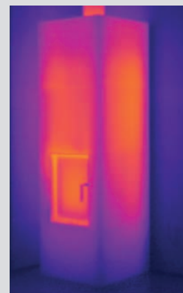
12 heures après l'allumage Température moyenne de surface 45 °C
